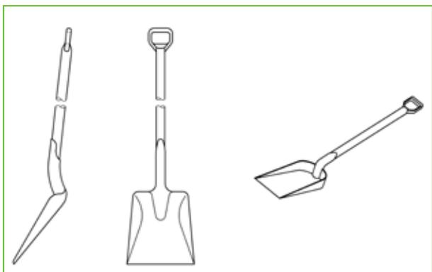
Abb. 10.3: Muster für Schaufel zur Probenahme von Halde (Breite: mind. 2,5-fache der Partikelgröße der Hauptfraktion) (entnommen aus [10-1])
