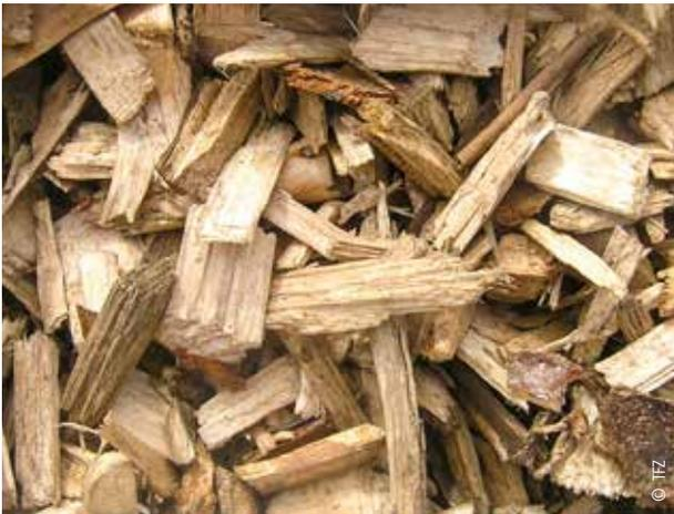
FrISChe WaldrestholzHackschnitzel vor (oben) und nach (unten) der Aufbereitung aus Fallstudie 6a mittels Schwingsieb und Bandtrockner. Holzrahmen in DIN A 5.
