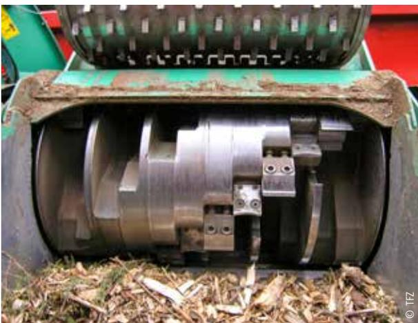
Beispiel für ein Schneidaggregat: Halbdurchlässige Hackertrommel mit versetzten Messern
