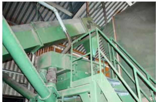
Allgaier Wälzbettrockner WB-T mit Zyklon (oben) und Backers Schwingsieb (unten)
