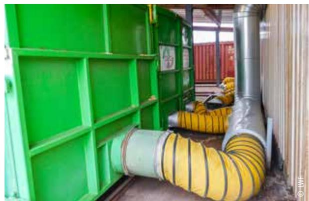
Trocknungscontainer angeschlossen an ein Gebläse
