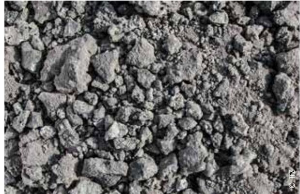
Beispiel für extreme Schlackebildung bei unpassender Brennstoffqualität, angefallen im Aschebehälter einer 1,3 MW Feuerung
