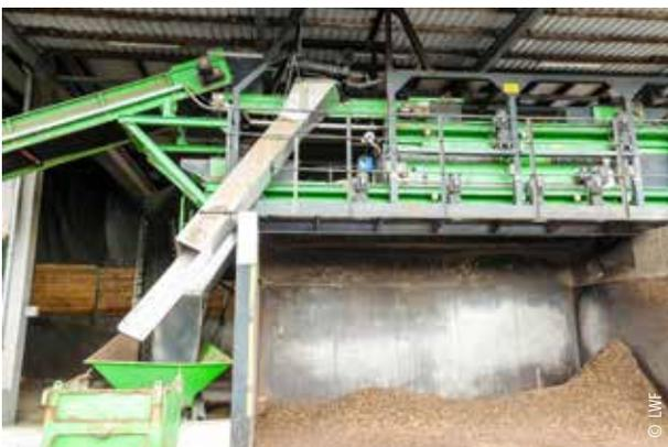
Containertrocknung (Satztrockner) mit Biogasabwärme (oben) und Siebung mittels Sternsieb (unten)
