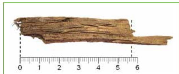
Abb. 10.7: Beispiel für die Bestimmung der Länge eines Hackschnitzels. Berücksichtigt wurde nur der Anteil, der einen Durchmesser von mindestens 7 mm aufweist. (Länge des Beispiel-Hackschnitzels: 57 mm)
